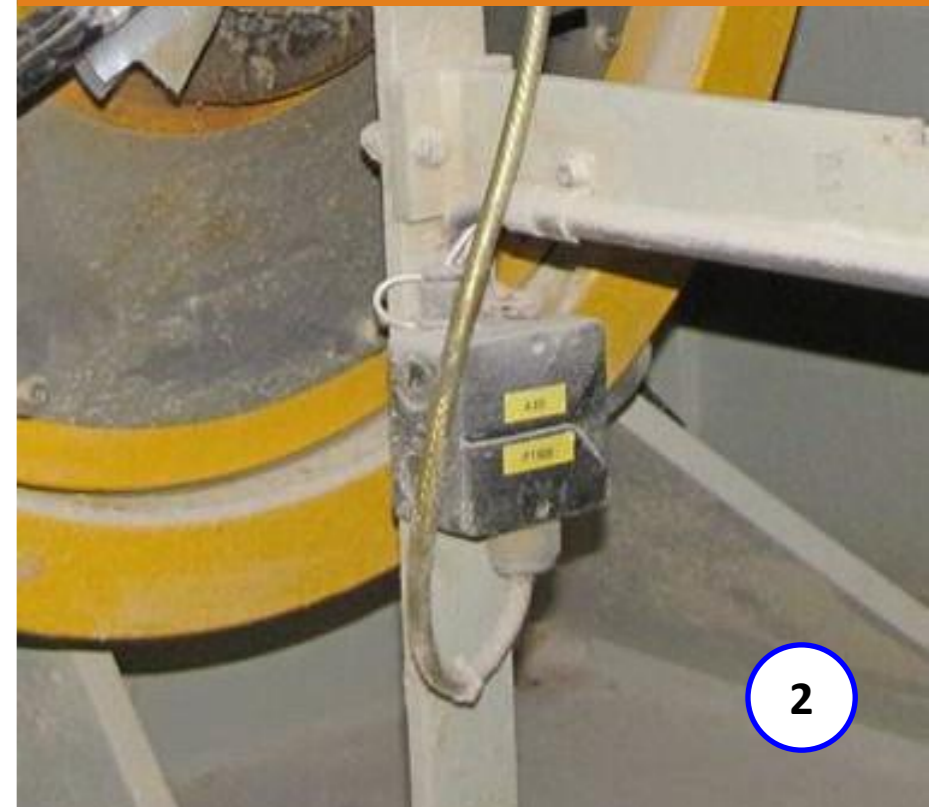
Centralni sustav podmazivanja (1), distribucija masti (2) na Salmatec preši
